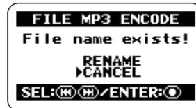
Setzen Sie den Cursor auf „RENAME“ und drücken Sie die Taste **(O)** (REC), um den Dateinamen zu ändern (→ S. 50). Alternativ setzen Sie den Cursor auf „CANCEL“ und drücken die Taste **(O)** (REC).
