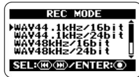
Hier können Sie den Aufnahmemodus auswählen. Die verfügbaren Einstellungen für das Dateiformat, die Samplingfrequenz und die Quantisierung sind unten aufgeführt.
