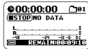
Dieser Bildschirm wird als „Top-Screen“ bezeichnet. Von hier greifen Sie auf die verschiedenen Funktionen des H2 zu. Sofern ein anderer Screen eingeblendet wird, drücken Sie wiederholt die Taste [MENU], bis der oben dargestellte Screen eingeblendet wird.
