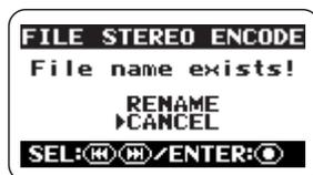
Setzen Sie den Cursor auf „RENAME“ und drücken Sie die Taste **(O)** (REC), um den Dateinamen zu ändern (→ S. 50). Alternativ setzen Sie den Cursor auf „CANCEL“ und drücken die Taste **(O)** (REC), um die Konvertierung abzubrechen.
