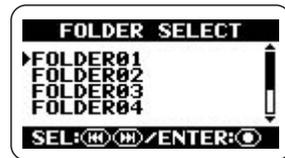
Anschließend drücken Sie die Tasten **◀** (REW)/**▶** (FF), um den Cursor auf den gewünschten Ordner zu setzen, und drücken Sie die Taste **●** (REC), um die Auswahl zu bestätigen.
