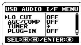
Im Betrieb des H2 als Audio-Interface können Sie über den Screen USB AUDIO I/F MENU auf folgende Funktionen zugreifen.
