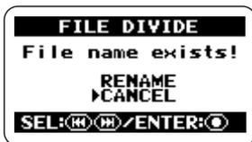
Setzen Sie den Cursor auf „RENAME“ und drücken Sie die **REC** (REC)-Taste, um den Dateinamen zu ändern (→ S.50) oder setzen Sie den Cursor auf „CANCEL“ und brechen Sie den Teilungsvorgang mit der **REC** (REC)-Taste ab.
