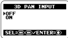
Setzen Sie den Cursor im entsprechenden Screen auf ON und drücken Sie die **[O]** (REC)-Taste, um das entsprechende Signal abzuhören. Abschließend wird wieder das Menü 3D PAN im Display angezeigt.
